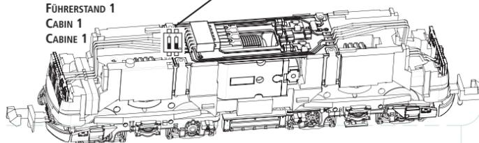
Hinweis: Die Stirnbeleuchtung der Lok kann mit Hilfe der DIP-Schalter S1 (für FS2) oder S2 (für FS1) auf der Platine für jede Lokseite abgeschaltet werden.
